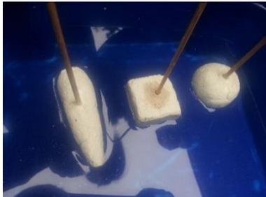
Forme aus Knete eine Kugel, einen Würfel und eine Spindel. Stecke in jede Form einen Holzspieß und ziehe diese Formen jeweils halb eingetaucht durch das Wasser. Achte dabei auf die entstehenden Wellen. Bei welcher Form sind sie am stärksten, bei welcher am geringsten?
